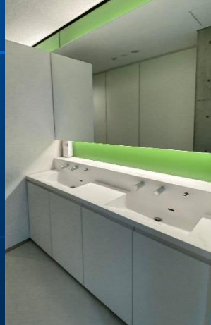
水量調整された跳ね返りの少ない 自動水栓
