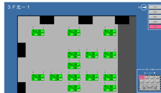
パーソナル吹出口操作画面
